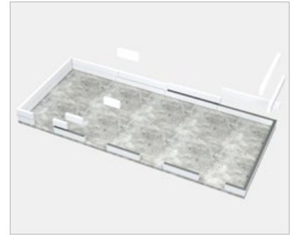
3. Montage ab der zweiten Lage in Dünnbettmörtel
