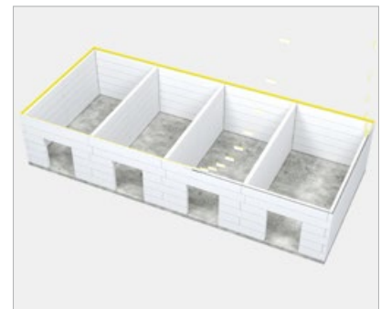
6. Setzen des Deckenabstellsteins
